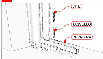
**7** Fissare la guida superiore, utilizzando il separapeli, e fissare la guida di riscontro.
